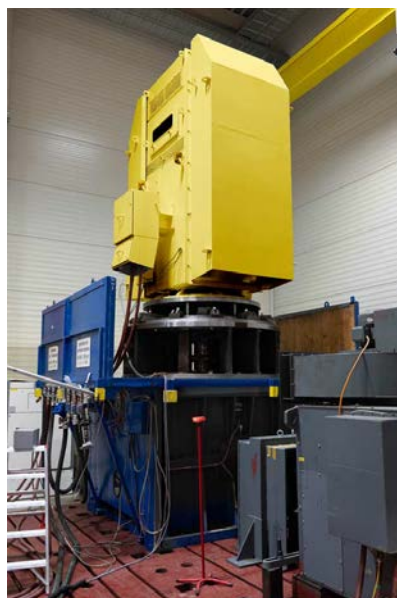
Bild: Menzel Elektromotoren führt ab sofort auch Lastprüfungen an großen Industriemotoren in vertikaler Einbaulage aus
