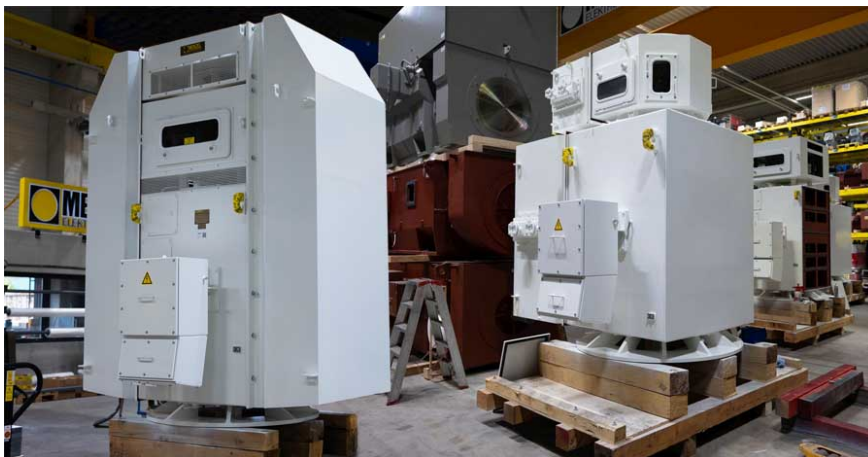
Bild: Menzel Elektromotoren fertigt maßgeschneiderte große Schleifringläufermotoren individuell für die Anwendung und nach Kundenvorgaben
