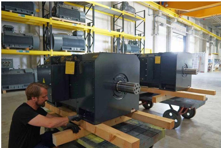
Bild: Zwei identische Gleichstrommotoren auf dem Weg zum Einsatz als Walzmotoren
