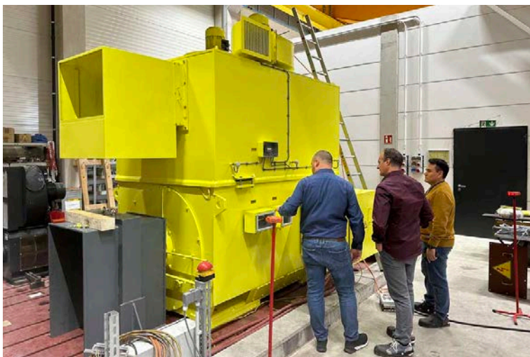
Bild: Menzel Elektromotoren prüft alle Motoren vor Auslieferung gründlich; hier: Prüftechniker, Vertriebspartner und Kunde im Lastprüffeld
