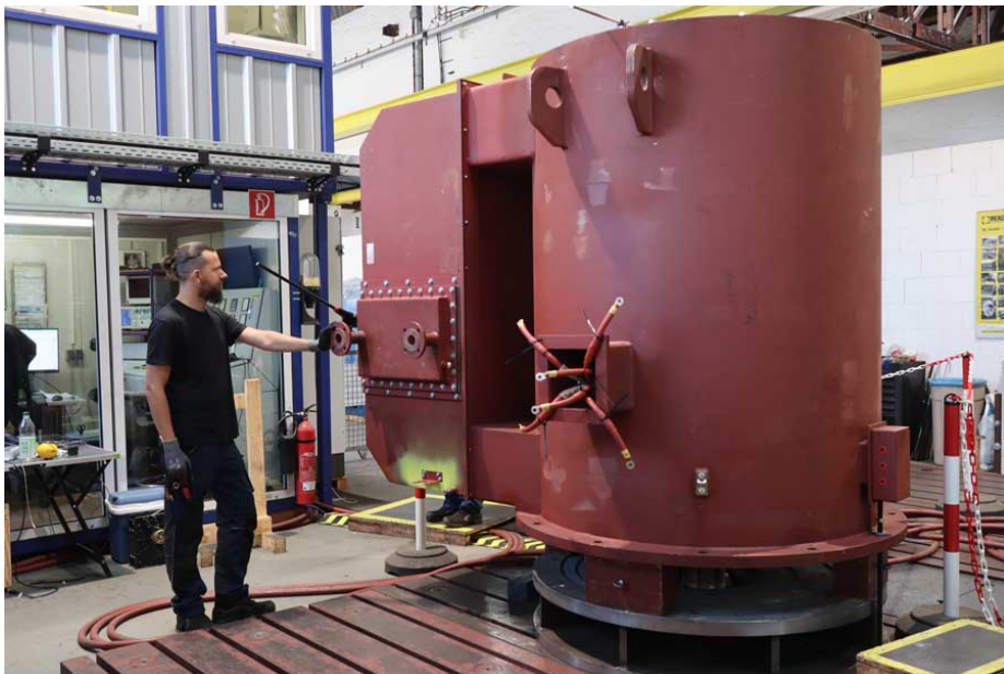
Bild: Der Sondermotor kann dank zwei separaten Wicklungen einen Schiffspropeller in zwei unterschiedlichen Geschwindigkeiten antreiben
