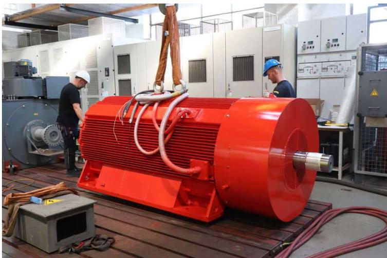
**Bild:** Drei identische Drehstromkäfigläufermotoren in BG 630 hat Menzel inklusive Gehäusen mit Rippenkühlung für den Einbau in Grubenlüfter maßgefertigt
