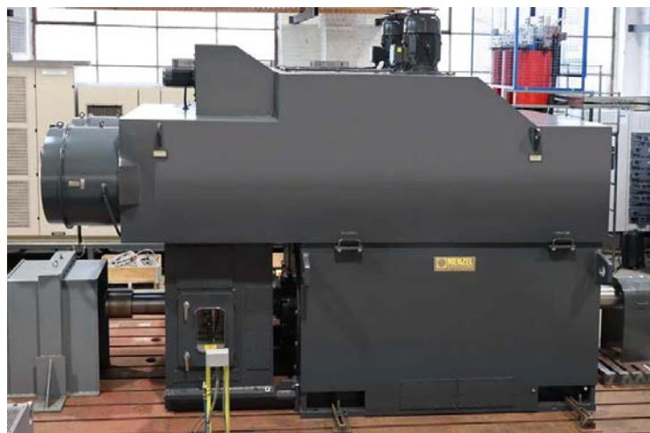
**Bild:** Der maßgefertigte Schleifringläufermotor mit zwei Wellenenden kann zwei verschiedene Mühlenmotoren sowie einen Ventilatormotor ersetzen – das spart Geld und Platz beim Ersatzteilmanagement
