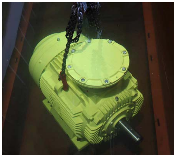
Bild: Menzels IP67-Motorserie sowie die IP67-Schutzartprüfung wurden vom TÜV Süd bescheinigt
