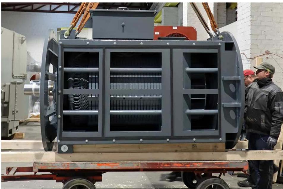
**Bild:** Der flexibel ausgelegte Ersatzmotor kann im Bedarfsfall Motoren für Zuckerrübenschnitzeltrockner in verschiedenen Zuckerwerken ersetzen
