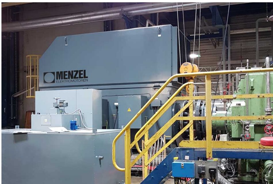
Bild: Ein kurzfristig passgenau konfigurierter Schleifringläufermotor erlaubte dem Petrochemieunternehmen, seine Extruderanlage schnellstmöglich wieder in Betrieb zu nehmen
