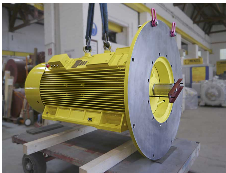
Bild: Menzel hatte einen passenden Motor vorrätig und nahm binnen Kurzem alle nötigen Anpassungen für die Pumpenanwendung vor, einschließlich Sonderflansch für Vertikalbetrieb
