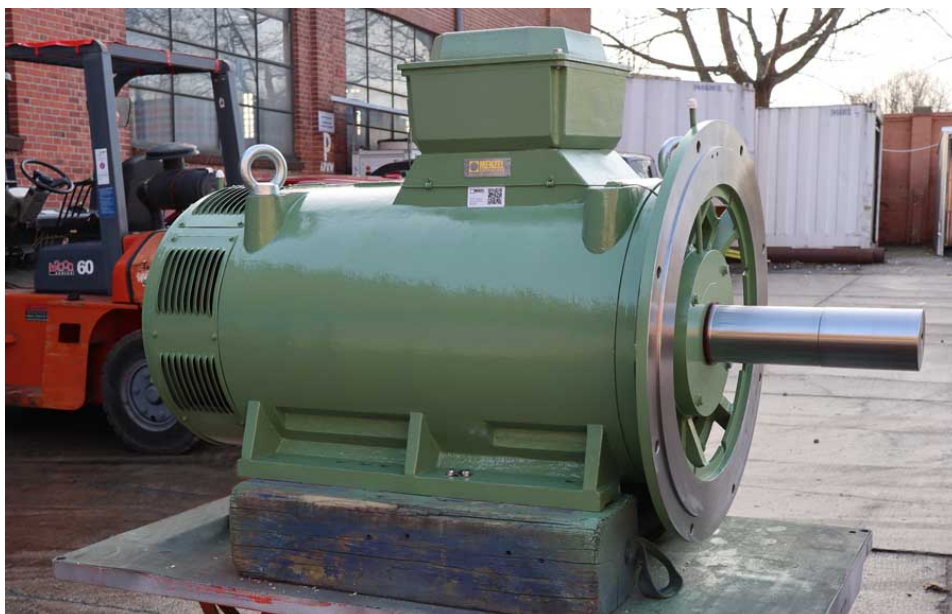
Bild: Menzel fertigte den Generator einschließlich Sonderwelle für die Anwendung mit großen Radialkräften
