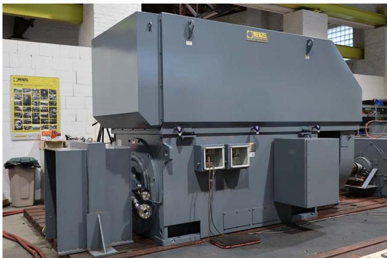
**Bild:** Menzel passte die Motoren den elektrischen und mechanischen Anforderungen an und prüfte sie abschließend im hauseigenen Prüfstand
