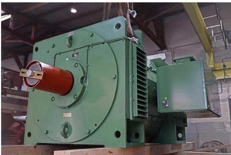
**Bild:** Menzel hat den Gleichstrommotor nach dem Muster eines alten Walzmotors so gebaut, dass er sowohl diesen als auch einen Haspelantrieb bei Bedarf ersetzen kann
