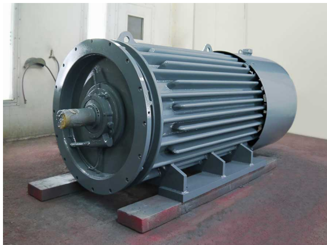
Bild: Menzels großes Motorlager deckt auch ungewöhnliche Ausführungen wie diesen 12-poligen Motor mittlerer Leistungsklasse ab
