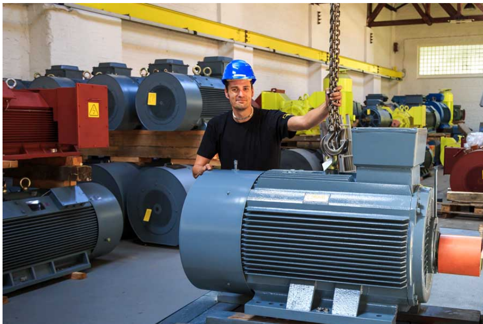
Bild: Der Berliner Motorbauer Menzel hat ein riesiges Lager mit fabrikneuen Nieder-, Mittel- und Hochspannungsmotoren bis 15 MW
