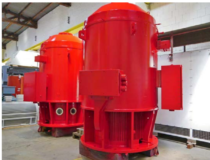
Bild: Menzel Elektromotoren fertigt die Vertikalmotoren komplett nach Maß – einschließlich handgeschweißten Gehäusen für effiziente Kühlung
