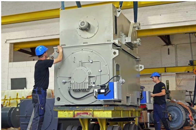
**Bild:** Der wassergekühlte Motor zum Antrieb eines Kolbenkompressors widersteht hohen Umgebungstemperaturen
