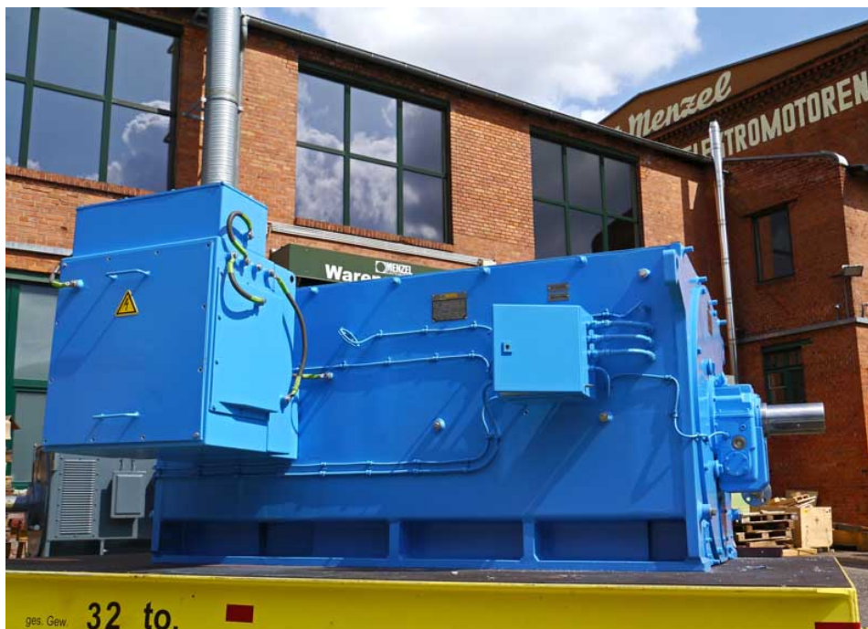
Bild: Menzel baute einen lagervorrätigen Motor innerhalb von nur drei Wochen komplett um, sodass er einen ausgefallenen Pumpenmotor ersetzen kann
