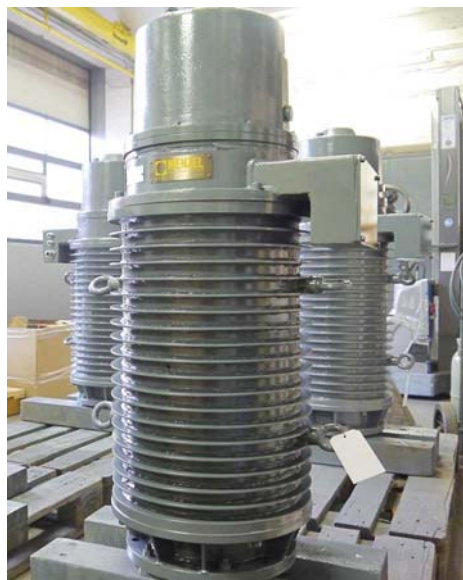
Bild: Menzel projiziert Ringrippenmotoren individuell für Anforderungen an Transport- und Arbeitsrollgängen wie erhöhte Stoß- und Vibrationsfestigkeit und Eignung für den Nassbereich
