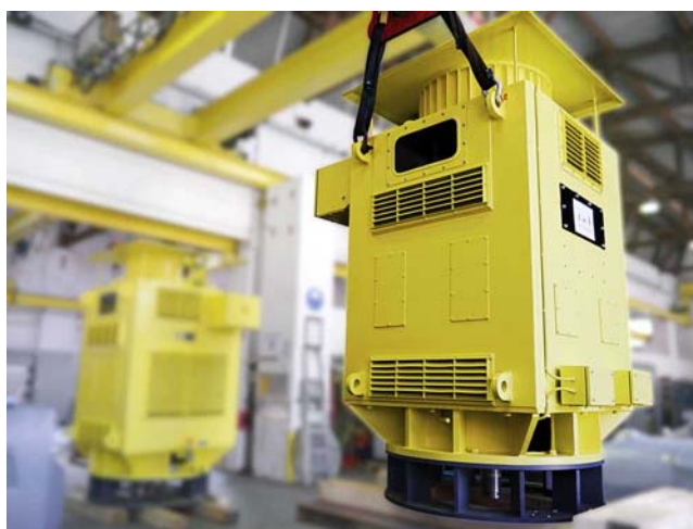
Bild: Menzel fertigte maßgeschneiderte Ersatzmotoren für ein Wasserwerk und führte die Lastprüfung durch
