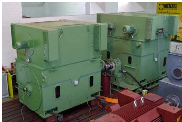
Bild: Das Antriebssystem für Transformatorenprüfungen wurde in Berlin gefertigt und unter Last geprüft
