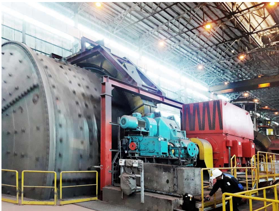
Bild: Der Antrieb für eine Kugelmühle, die Gestein zerkleinert, musste robust ausgelegt werden, um Staub und Schwingungen zu widerstehen
