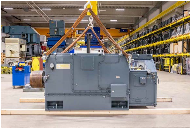
Bild: Menzel Elektromotoren baute einen lagervorrätigen Schleifringläufermotor kurzfristig für den Metallschredder um
